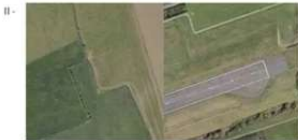
Rase campagne, avec ou non quelques obstacles isolés (arbres, bâtiments, etc.) séparés les uns des autres de plus de 40 fois leur hauteur.
