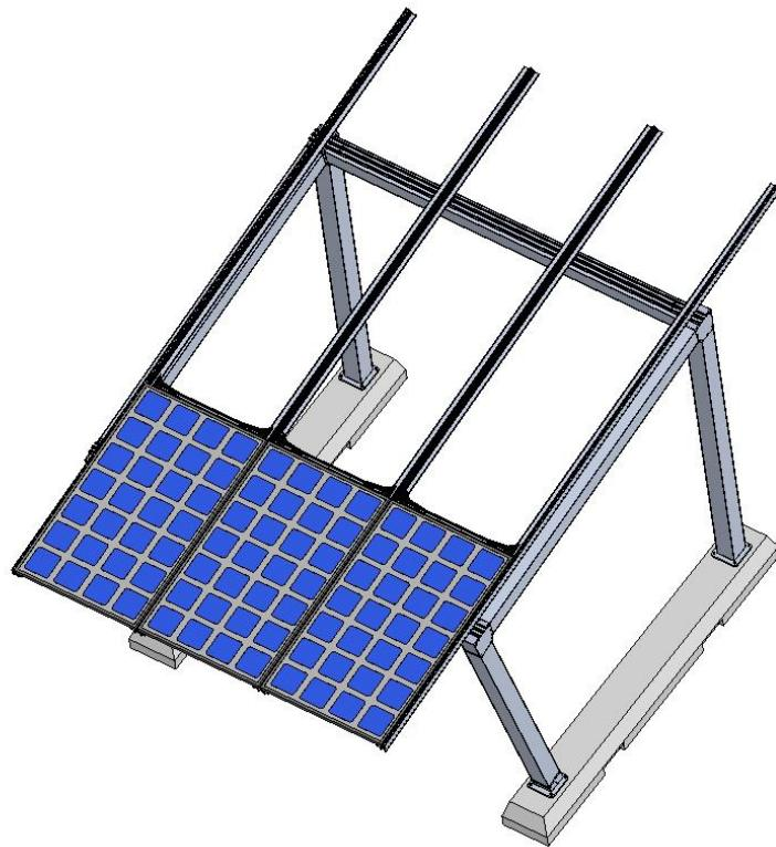
Après avoir placé les 3 ensembles de joints d'écoulement réglables, montez les 3 modules photovoltaïques suivants.
