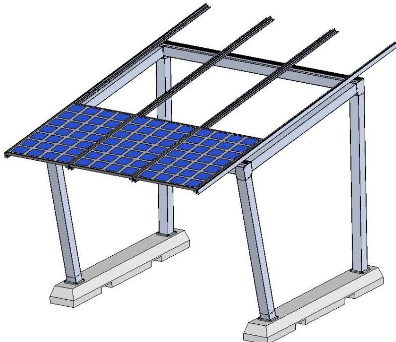
Une fois que les 3 modules de fin de champs ont été posés en étant toujours maintenus avec les serre-joints, ajoutez un ensemble de jonctions d'écoulement réglables sous chacun des trois modules.
